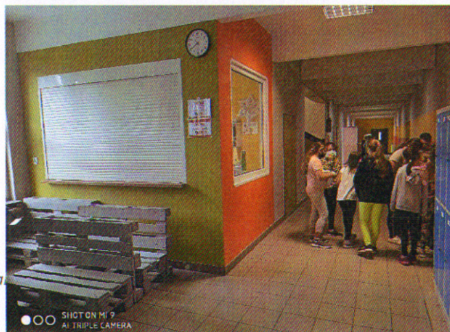
Zdj. Na granicy strefy pożarowej (hala sportowa/szkola) odległość między otworami w ścianach sąsiednich stref mniejsza - 1,25 m
